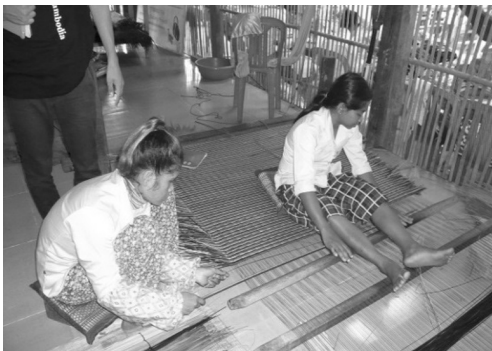
写真3 簾を編む工程
